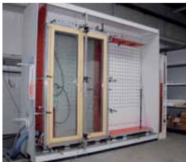
Preizkus: trajnost, tesnjenje pri nalivih, obstojnost na vremenske spremembe.
